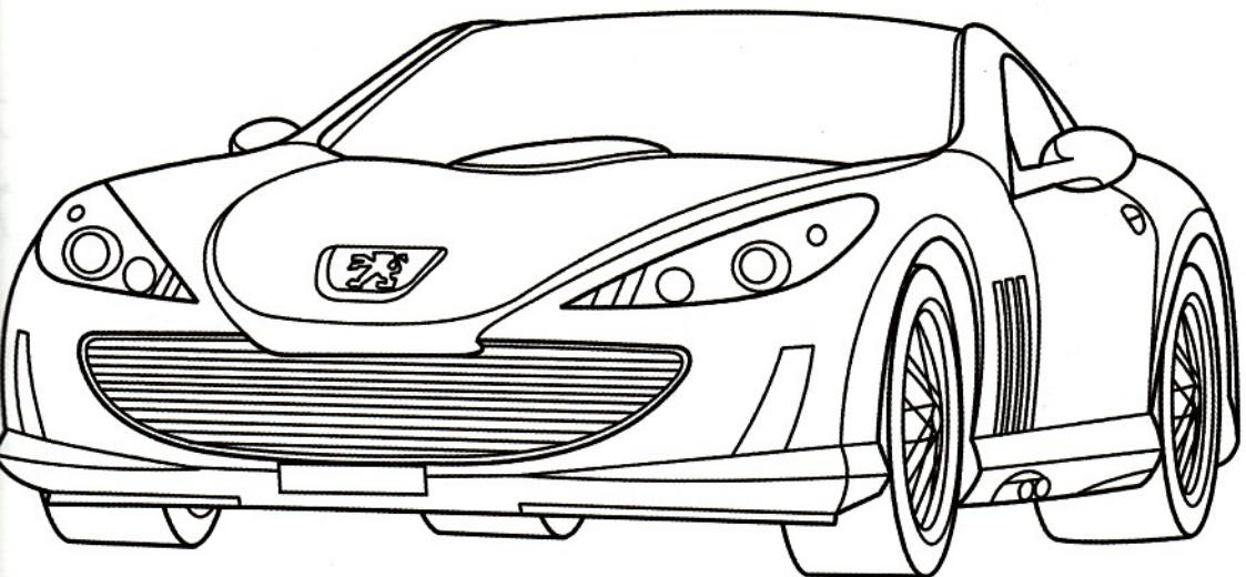
Спортивное купе Peugeot 907. Привод задний, типичный для спортивных машин. На большой скорости из ниши позади кабины выдвигается спойлер. Спереди новинка выглядит довольно агрессивно за счёт огромного воздухозаборника в переднем бампере и вытянутых фар. Двигатель у Peugeot 907 – 6,0 л, мощность 500 лошадиных сил.
