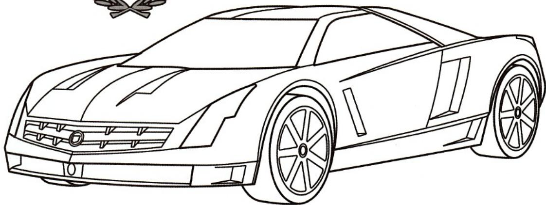
Для компании Cadillac концепт Cien – это не серийная модель. Концепт входит в число флагманов-спорткаров, которые являются «лицом фирмы». Двигатель объёмом 7,5 л хорошо виден через заднюю прозрачную крышу кузова. Полностью алюминиевый мотор выдаёт 750 л.с. Корпус сделан из углеродного пластика для увеличения прочности. Такой материал используется в конструкции самолётов-истребителей.
